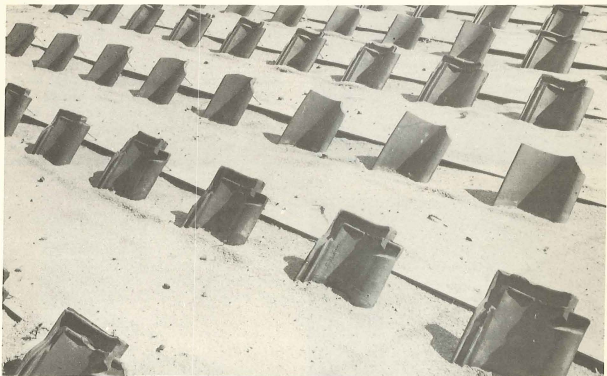
Fig.15 Hjørne af Kalk- og Teglværkslaboratoriets "Tagstenskirkegård", hvor tagstensprøver fra danske tagstensværker er anbragt halvt nedgravet i sand. Området ved jordskorpen udsættes derved for meget hård påvirkning i frostvejr, således at der på relativt få år kan ventes at være mulighed for at give tagstenene "karakter" for frostfasthed.
