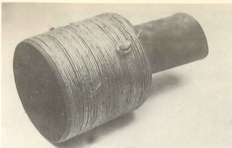
Fig.1. Murstenscylinder til vandgennemtrængelighedsprøvning. Cylinderen er anbragt i en gummislange med surring til sikkerhed for, at vandet ikke undviger gennem cylinderfladen.
